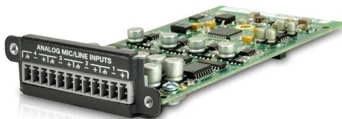
Die analoge Eingangskarte stellt vier Kanäle für Mikrofon-/Line-Eingänge mit +48 Volt Phantomspeisung, 54 dB Verstärkung und 24 dB Trimmung zur Verfügung. Die Eingänge sind elektronisch symmetrisch und werden über eine Buchsenleiste zur Verfügung gestellt. Die Steuerung jedes Eingangs umfasst Verstärkung mit Pegelanzeige, PegelEinstellung, Mute und Signal-Invertierung.
