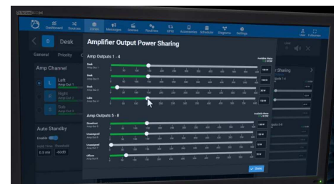
AZMP8: Flexible Leistungsaufteilung pro Zone durch „Power-Sharing“-Verstärker-Technologie
