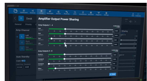
AZMP8: Flexible Leistungsaufteilung pro Zone durch „Power-Sharing“-Verstärker-Technologie
