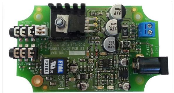
Der Induktionsschleifenverstärker IL-A42 ist für den Einbau in Geräte von Drittherstellern konzipiert. Er bietet eine integrierte Lösung für Maschinen und Geräte, die eine Hörschleife für die Nutzung in Zweiergespräche benötigen.
