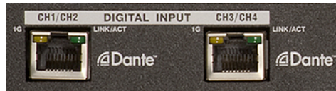
Abbildung 3.18: 4Xi/4Xe Serie - Dante™ Ports
