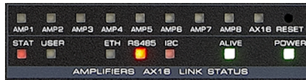
Abbildung 3.60: SXL II - LEDs auf der Vorderseite
