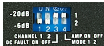
Abbildung 3.30: XV DC Serie - DIP Schalter
