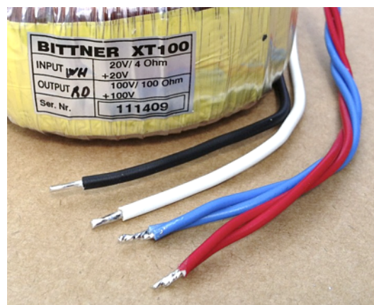
Abbildung 3.35: XT Übertrager - Anschlussdrähte und Aufkleber
