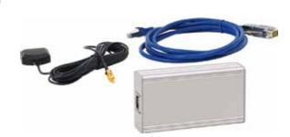
Das Time Control Modul wird direkt an das DOM4-8/4-24 angeschlossen und gewährleistet eine Zeitsynchronisation über das GPS Signal. Das ermöglicht zeitgenaue, automatisierte Durchsagen (z.B. der Pausengong in Schulen), zeitgesteuerte Lautstärkeanpassungen (z.B. Nachtabsenkung in Bahnhöfen) oder einfach nur zeitgenaue Protokollierung von Durchsagen oder Störmeldungen.
