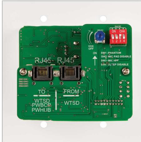
Das WTSD-MIX31K Mixer-Anschlussfeld wurde entwickelt für Innen- und Außenanwendungen, bei denen Audio aus verschiedenen Zuspiegeln oder Mikrofonen über Kabel oder drahtlos einfach direkt im Veranstaltungsbereich an die installierte Beschallungsanlage übertragen und bei Bedarf auch gemischt werden soll.
