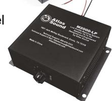
Der **M2000-SM** ist eine Sound Masking Lösung für Bereiche, in denen Abhörsicherheit gefordert ist. Er besteht aus einem Wandler und einem Übertrager. Der Wandler wird an glatten Oberflächen wie Fenstern, Türen, Wänden oder Luftschächten befestigt. Er stört Abhörgeräte, indem er mit NXT™ Exciter Technologie die jeweilige Oberfläche zum Vibrieren bringt. Der Übertrager besitzt Abgriffe für 0,25, 0,5, 1,2 und 4 Watt. Er arbeitet mit allen Sound Masking Generatoren von Atlas.
