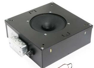
Der **M2000-LP** ist ein besonders flacher Sound Masking Lautsprecher, der zum Beispiel unter Fußböden, in Einbaumöbel oder anderen Einbauten eingesetzt wird. Der Lautsprecher besitzt einen doppelten 2" x 4" Lautsprecherkonus aus Papier. Der integrierte 70/100 Volt Übertrager hat Abgriffe für 0,25, 0,4, 1, 2 und 4 Watt. Die Lautsprecher sind nach UL1480 und UL2043 zertifiziert.
