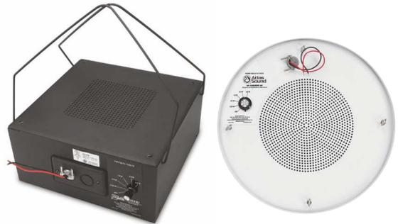
Der **M812-S2T7-BX-RS** ist ein 8" Sound Masking Lautsprecher mit doppeltem Konus, der speziell für die akustischen Anforderungen abgehängter Decken konzipiert wurde. Um einen zügigen Einbau zu ermöglichen, ist er fertig zusammengebaut und verdrahtet. Die Übertragerabgriffe (0,5, 1, 2 und 5 Watt) liegen außerhalb des Gehäuses und können so bei der Installation einfach eingestellt werden. Der M812-S2T7-BX-RS ist nach UL1480 zertifiziert.
