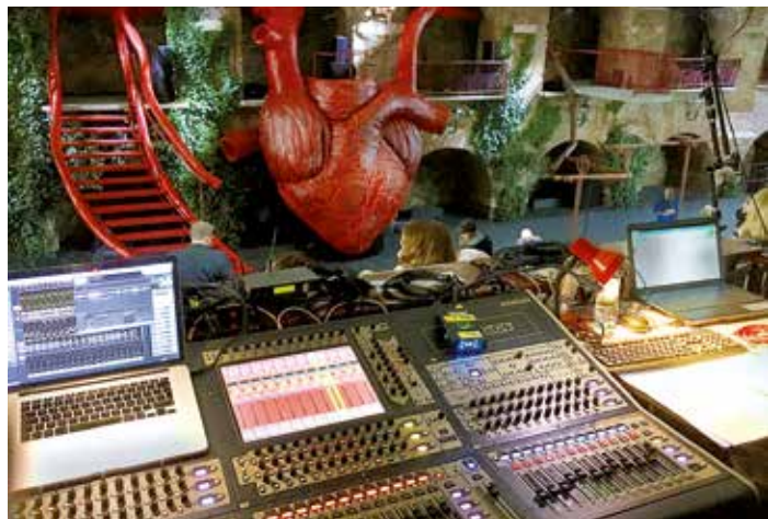
Opernhausakustik für die Open-Air-Inszenierung: Am FoH erfolgt die Steuerung der Lautstärkenbalance und des Showablaufs
