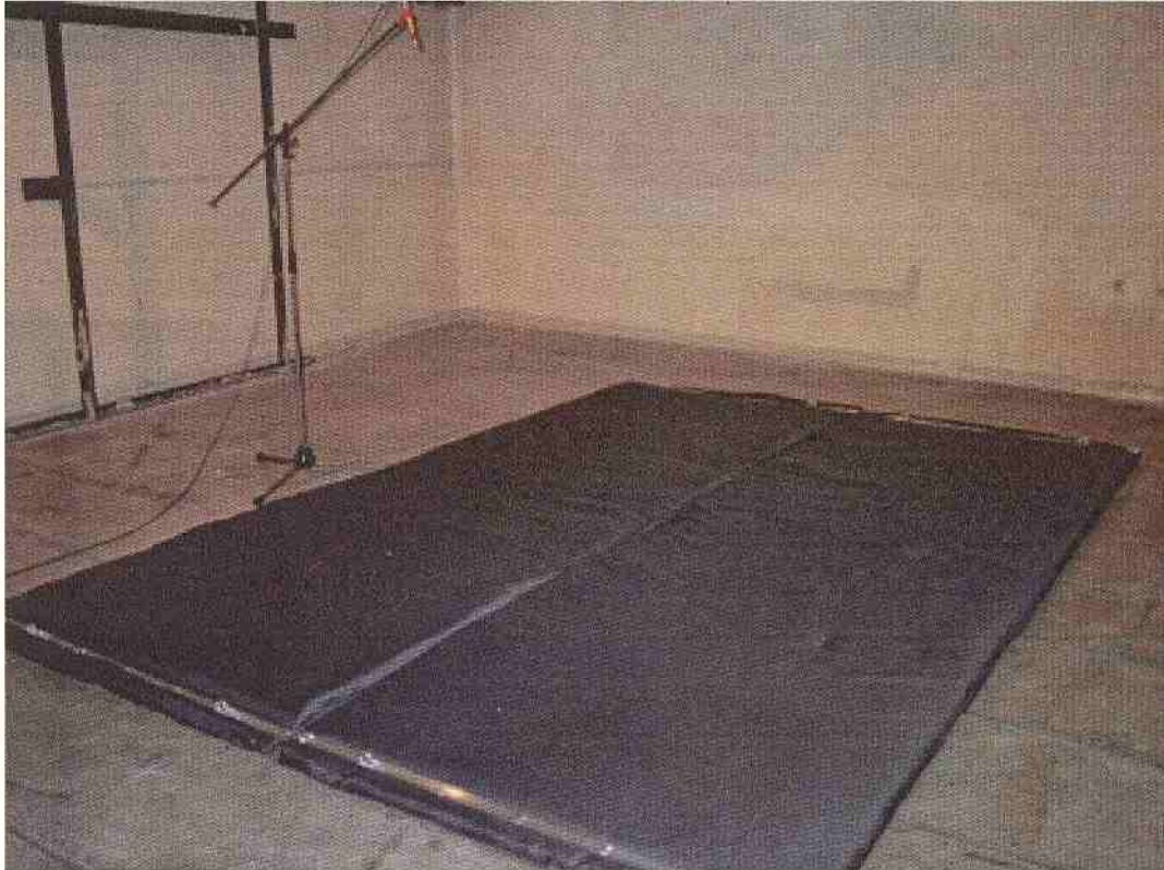
Bild 1 zu Prüfbericht 07017. Anordnung der Akustiksegel acouSon auf dem Messraumboden.
