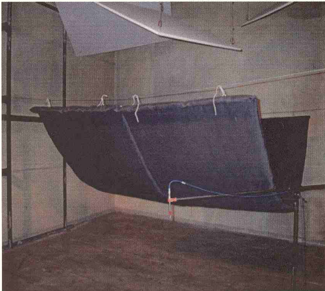
Bild 2 zu Prüfbericht 07017. Gehängte Akustiksegel acouSon im Messraum.
